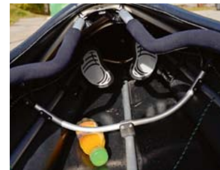
Spant Nr. 3 hängt in der Luft und drückt.
