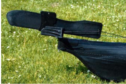
Das Steuerruder lässt sich vom Cockpit aus bequem über das Heck ziehen.
