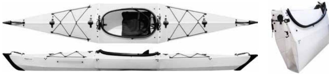
Das **nortik fold 4.2**: ein Boot aus einer faltbaren Platte, in wenigen Minuten aufgebaut und in der Performance einem Hartschalenskajak ähnlich. Das Prinzip heißt »Origami«.
