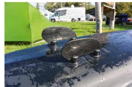
Bild oben: das Puffin Saranac im Solo-Einsatz mit Verdeck. Bild unten: Der Doppelskeg verbessert die Spurtreue noch weiter.
