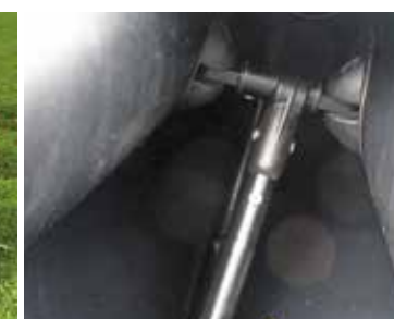
Noch mehr Steifigkeit: kleine Stange zwischen Steven und Bootshaut.
