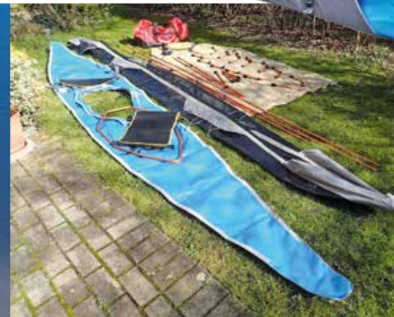
Bootshaut und Verdeck, Gestänge, Sitzanlage, Süllrand und Tragetasche: der Lieferumfang des Pakboats Quest 150 säuberlich ausgebreitet.
