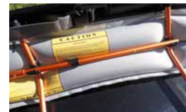
Bild oben: Versteifungsrohre in Bug und Heck. Unten: die horizontalen Stangen für die Montage der Sitzanlage.
