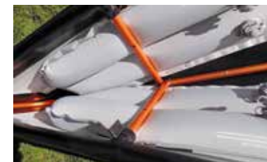
Bild oben: Versteifungsrohre in Bug und Heck. Unten: die horizontalen Stangen für die Montage der Sitzanlage.
