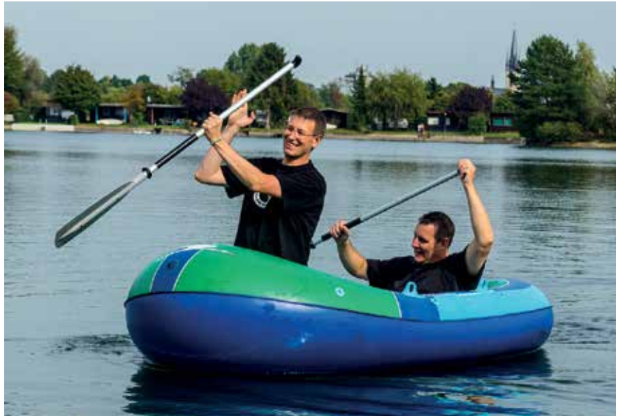
Das Aldi-Boot von der Firma Crane ist sehr kippstabil. Vorsicht ist jedoch bei stärkerem Wind geboten. Durch die wulstige Form bietet es jede Menge Angriffsfläche. Das kann am Meer bei ablandigem Wind leicht gefährlich werden.
