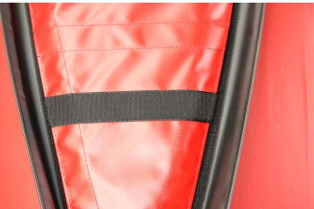
Der Vedeck wird aufgekleftet. Fangen Sie am besten vorne an der Spitze des Cockpits an und kletten es fest. Linkes Bild zeigt die vordere Spitze des Verdecks.
