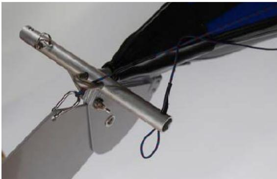
Führen Sie dann die Enden der Steuerleine durch das Loch des Querbalkens...
