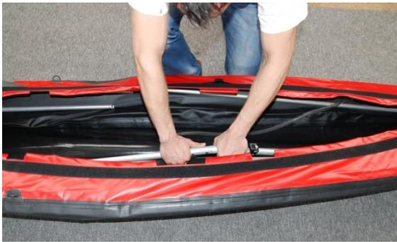
Drücken Sie den eingehängten Kiel langsam nach unten. Gerade beim ersten Mal entsteht hier eine hohe Spannung. Das ist normal und wird nach einigen Aufbauten etwas weniger.
