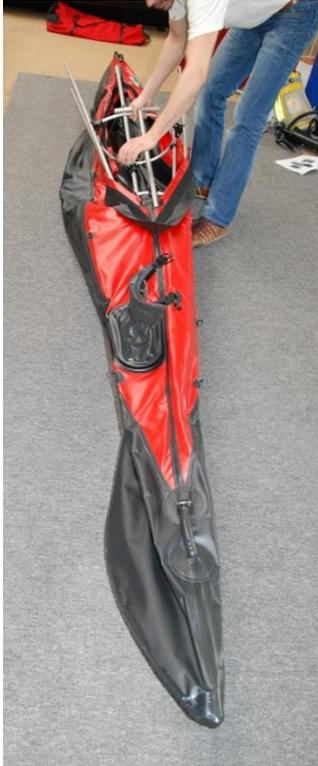
Breiten Sie die Bootshaut aus. Öffnen Sie die Ladeluke am Bug und öffnen Sie den wasserdichten Wickelverschluss. Führen Sie dann das Bugelement in die Bootshaut ein. Achten Sie darauf, dass Sie das Gestänge mittig einsetzen.
