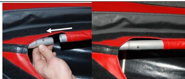
Verbinden Sie dann das Süllrandrohr mit dem Aufnehmer im Bug, indem Sie es darauf schieben. Hier können Sie den beweglichen Aufnehmer etwas zu sich her ziehen, so dass auch hier eine Gerade entsteht und so das Auffädeln des Süllrandrohres leichter ist.
