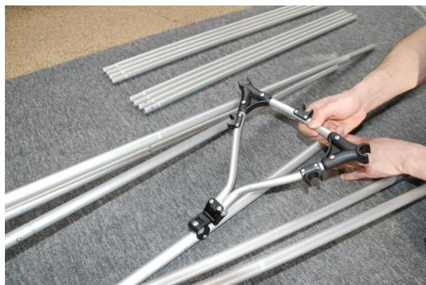
Nehmen Sie dann Spant #1 zur Hand. So wie dieser werden alle Spanten nach der gleichen Systematik eingesetzt:
