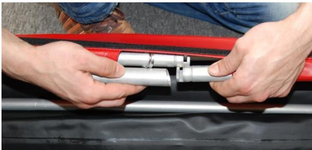
Nehmen Sie anschließend eine der beiden größeren Schiebehülsen zur Hand und stecken Sie auf das Süllrandrohr. Die Verbindung der beiden Süllrandrohre mit Schloss erfolgt ähnlich wie bei den Senten.
