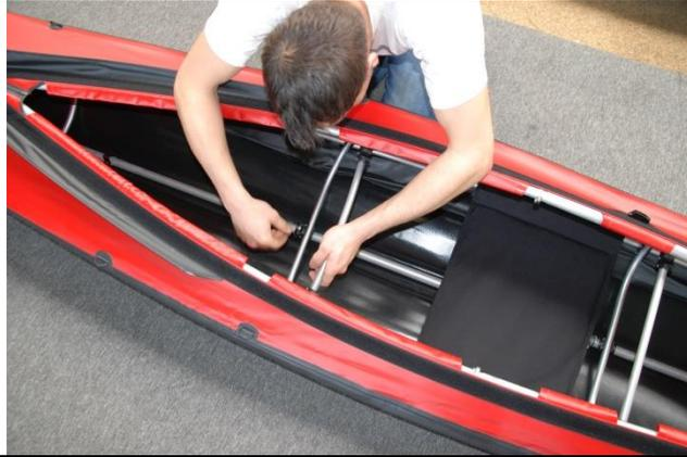
Clipsen Sie alle Senten in die CLipse des Spantes. Denken Sie bitte an den „idealen Griff“ wie oben bei der Installation von Spant #4 beschrieben.
