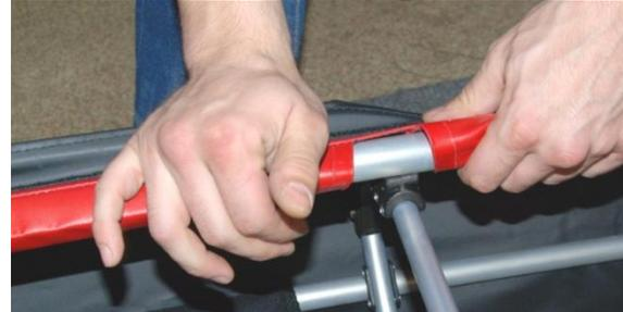
Wenn dies etwas schwerfällig geht, „schieben“ Sie den Süllrand mit der Handfläche über den Spant, wie linkes Bild zeigt.
