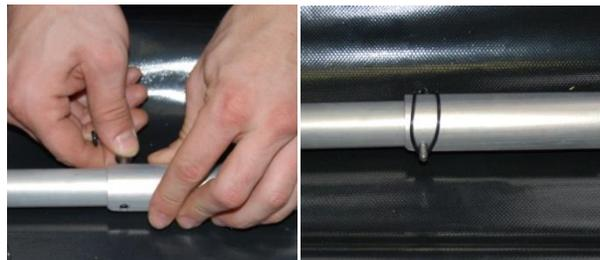
Stecken Sie dann den Splint wieder durch die Löcher und schlagen den Gummi oben herum darüber.
