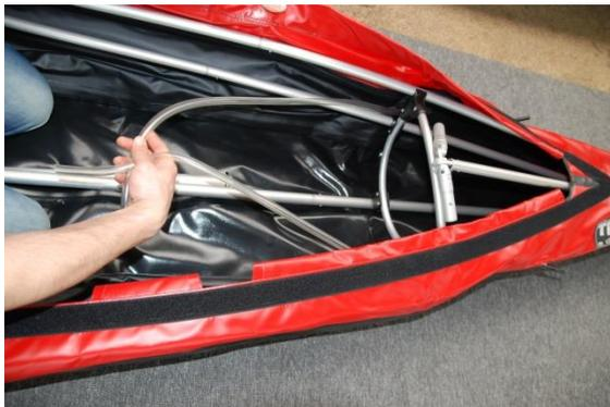
Nun wird Bug und Heck miteinander verspannt. Entfernen Sie dazu **bitte** erst den Splint des Kielrohrs. Und gehen Sie dann **bitte** genau so vor wie beschrieben **und lesen Sie den Abschnitt bitte zunächst einmal durch** bevor Sie ans Werk gehen:
