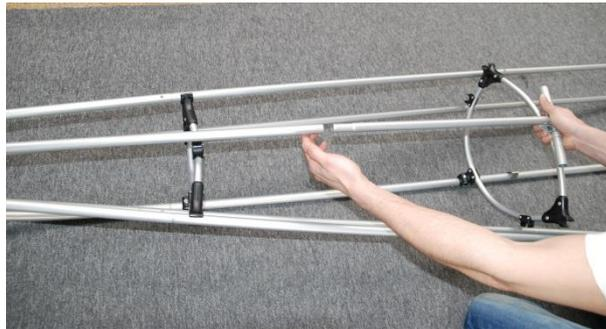
Das Einsetzen des Spants #2 und das Einführen des Firststabs in die Verlängerungssente **muss gleichzeitig erfolgen.**
