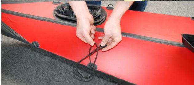
Die Decksbeleinung können Sie auf unterschiedliche Art und Weise installieren. Ein Vorschlag ist, dass Sie eine Schlaufe bilden, diese durch den mittleren D-Ring führen und die beiden Enden der Beleinung wiederum durch die Schlaufe, siehe Bilder links. Sie können die Beleinung aber auch nach Ihren Vorstellungen einfädeln.
