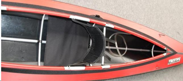
Die unteren Spanngurte werden jeweils am Spant hinter dem Sitz befestigt.
