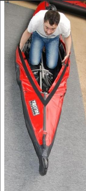
Schieben Sie es dann kräftig in den Bug, soweit es Ihnen möglich ist. Achten Sie darauf, dass die beiden Aufnehmer am Firststab in Richtung Kajakmitte zeigen (hier wird später der Süllrand aufgefädelt).
