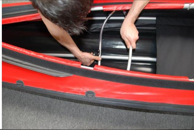
Setzen Sie nun den Spant #3 ein. Dies erfolgt wie bei Spant #4.
