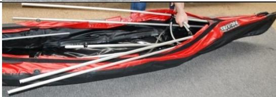
Verfahren Sie identisch mit dem Heck. Führen Sie auch hier das Gestänge **flach** und soweit wie möglich ein. Achten Sie darauf, dass Sie die Befüllschläuche für die seitlichen Luftschläuche zwischen die Senten nehmen.
