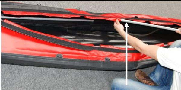
Stecken Sie eines der gebogenen Rohre **mit** D-Ring mit einem der kurzen Rohre zusammen.
