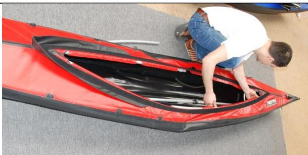
Schieben Sie dann jeweils die noch verbleibenden zwei Süllrandrohre ohne D-Ring in den Kanal in Richtung Heck und verbinden diese mit den beweglichen Aufnehmern im Heck.
