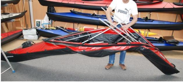
**WICHTIG:** Nehmen Sie vor diesem Vorgang die Senten **aus der Haut**. Dadurch entlasten Sie den Kiel und entsteht keine Blockade. Man kann Bug und Heck ohne Behinderung nach oben ziehen, die Haut kann knicken und kein Gestänge blockiert in der Haut. Sie sehen das sehr deutlich auf den beiden nebenstehenden Bildern. Wenn die Senten nicht aus der Haut genommen werden, entsteht ein ungünstiger Druck auf die Kielstangen, der diesen schaden kann.
