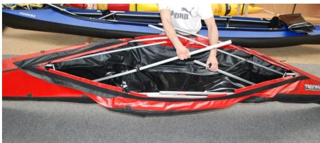
Das heißt, man zieht Heck und Bug nach oben („Heck über Bug“), hängt das Kielrohr #4 **unter** das Kielrohr #3 mit dem aufgenieteten Halbrohr und drückt das Ganze dann vorsichtig nach unten.
