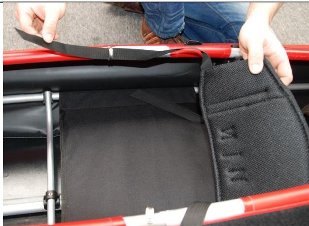
Installieren Sie dann bitte die Lehnen. Führen Sie den oberen Spannungsgurt durch den D-Ring am Süllrand.
