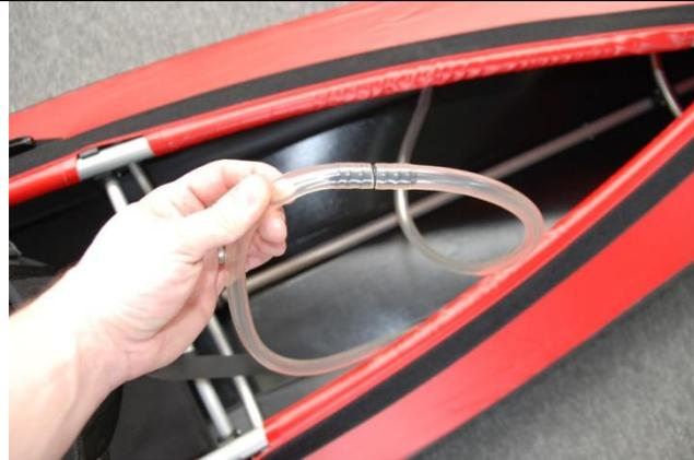
Blasen Sie nun bitte die seitlichen Luftschläuche auf. Diese werden danach mit Hilfe des Verbindungsrohres miteinander verbunden. So findet ein Druckausgleich statt, welcher ein stets symmetrisches Unterwasserschiff garantiert.
