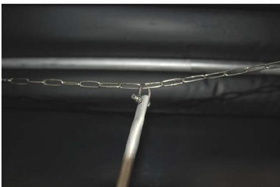
Platzieren Sie dann den Steuerbalken an der gewünschten Stelle, indem Sie die Schekel durch das gewünschte Kettenelement führen und den Stift durch das Loch am Steuerbalken.
