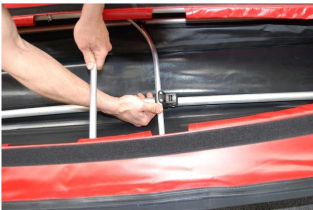
Nehmen Sie dann den Spant #4 zur Hand und setzen diesen wie gewohnt schräg an.
